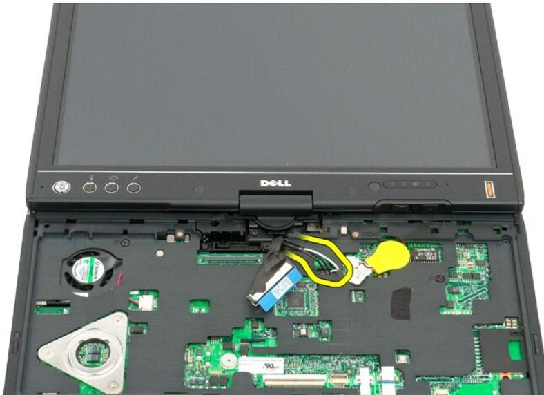
10. 卸下將顯示幕組件固定在 Tablet PC 上的五個螺絲。
