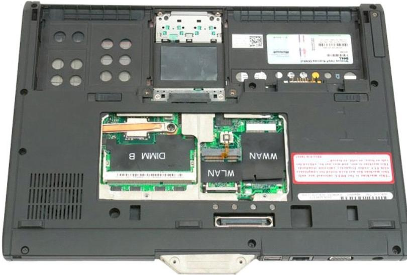
7. 從 Tablet PC 底部卸下固定手掌墊的九個螺絲。
