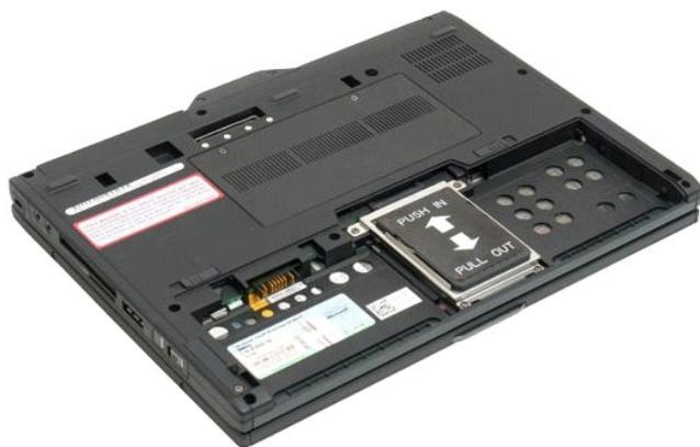
3. 卸下記憶體與迷你卡護蓋上的兩個緊固螺絲。
