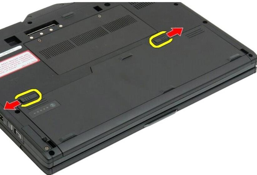
3. 將電池滑出電池凹槽。
