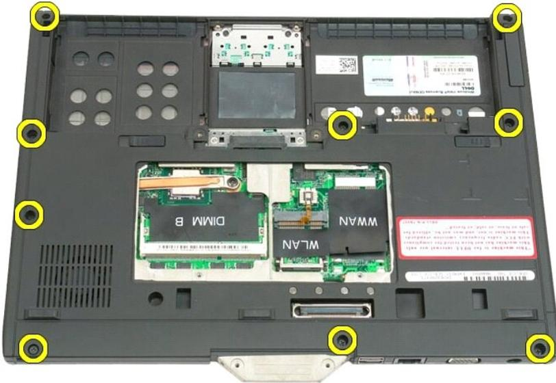
8. 翻轉 Tablet PC 並卸下將手掌墊固定至 Tablet PC 正面的三個螺絲。
