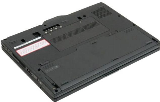
2. 將 Tablet PC 底部的兩個電池凹槽釋放門鎖向外滑動至兩側。
