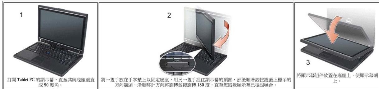
當您在手提電腦模式和 Tablet 模式之間轉換 Table PC 時，Table PC 的螢幕方向會根據您在 Dell Control Point System Manager 應用程式或 Windows Vista 筆和 Tablet 設定應用程式中建立的設定自動變更，通常是從橫向 (手提電腦模式) 變更為縱向 (Tablet 模式)。
