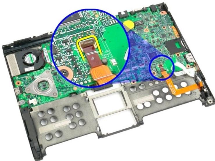
19. 卸下將主機板固定至底部塑膠的一個螺絲。
