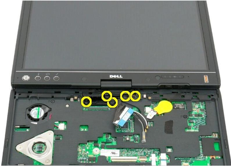
11. 將顯示幕組件垂直向上提起以使其脫離 Tablet PC。
