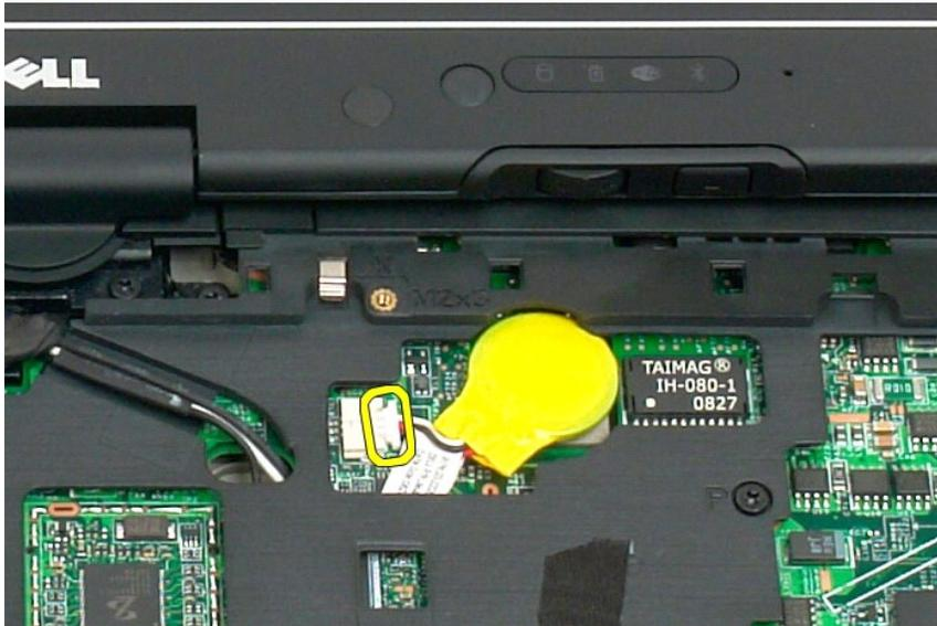
6. 從將幣式電池黏合至主機板的黏合劑輕輕撬起 (鬆動) 幣式電池，然後將其從 Tablet PC 上卸下。
