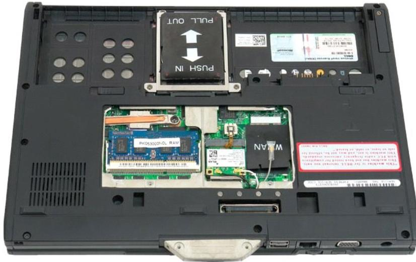
6. 從 Tablet PC 底部拔下所有天線纜線。
