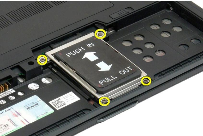
4. 卸下硬碟機托架。
