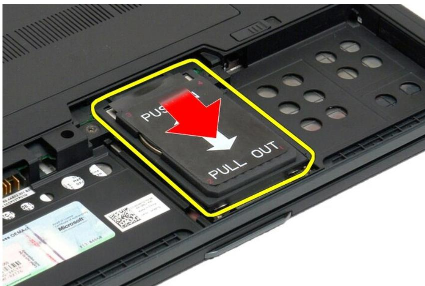
6. 從 Tablet PC 上卸下硬碟機。
