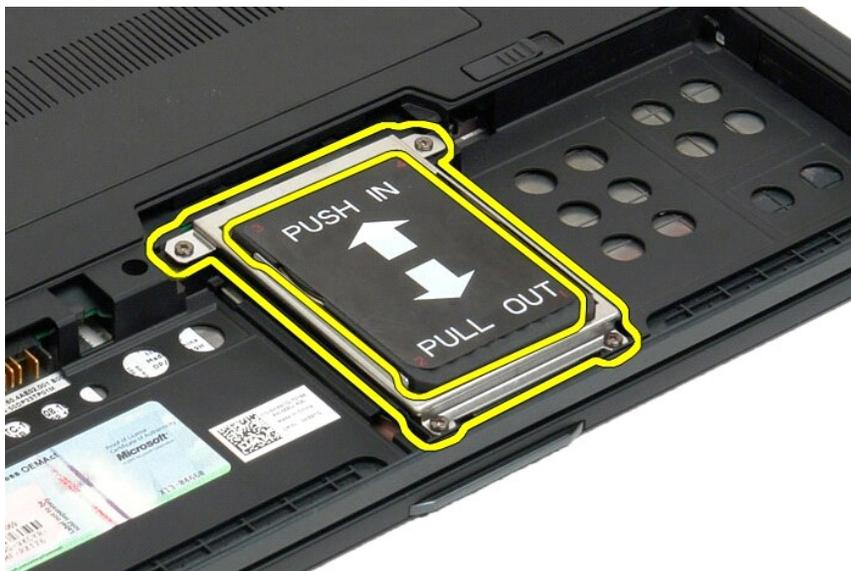
5. 將硬碟機滑向 Tablet PC 的邊緣以斷開其與主機板的連接。
